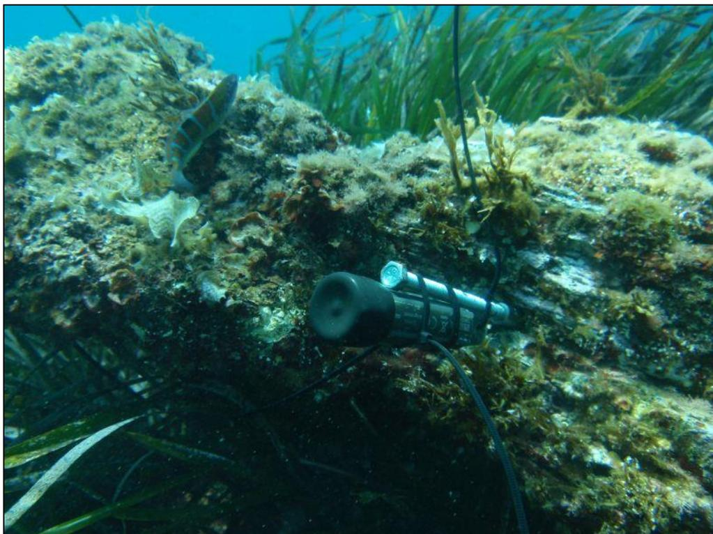
**Figura 3.b.1.** Sensor HOBO de temperatura puesto a - 5 m de profundidad.
