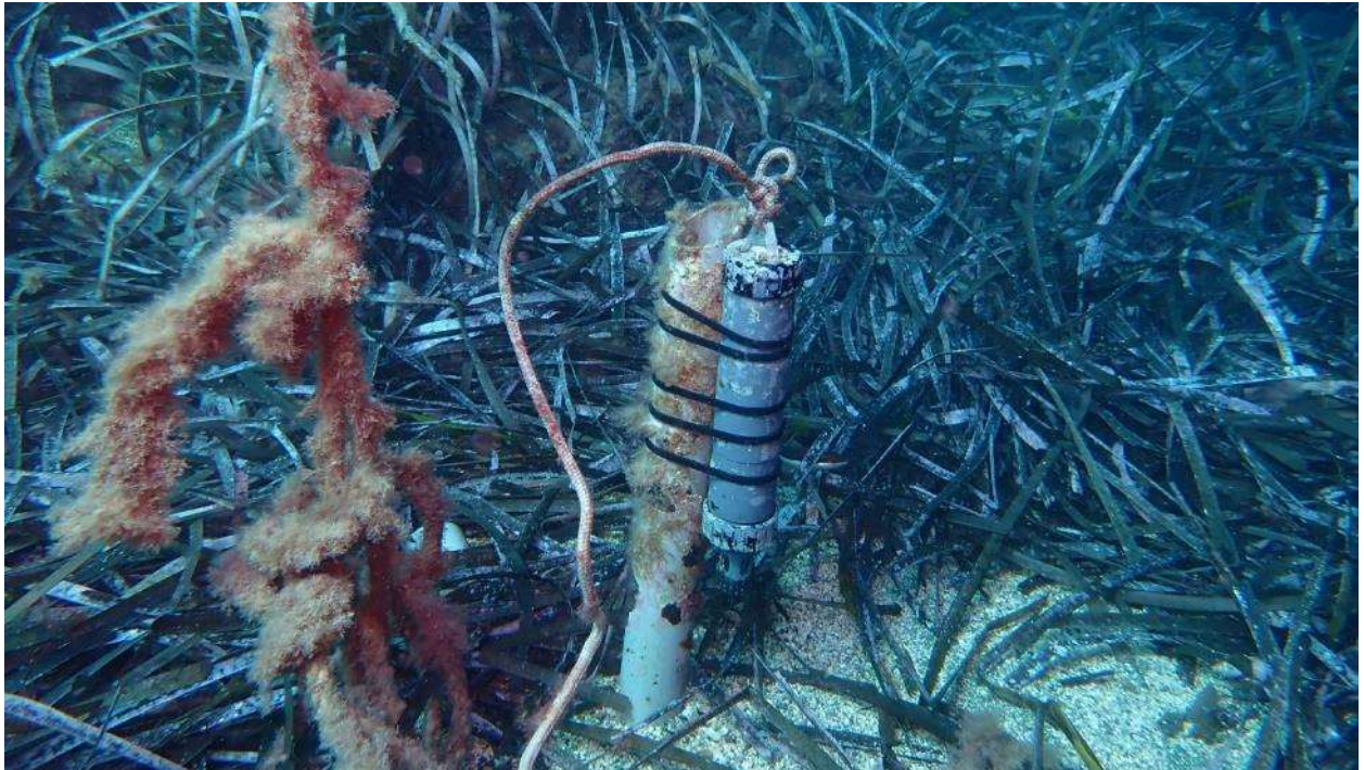
Fotografía 4-9. Sensor de temperatura y Ph, una vez fijado en el soporte fondeado en la Reserva Marina de Tabarca.
