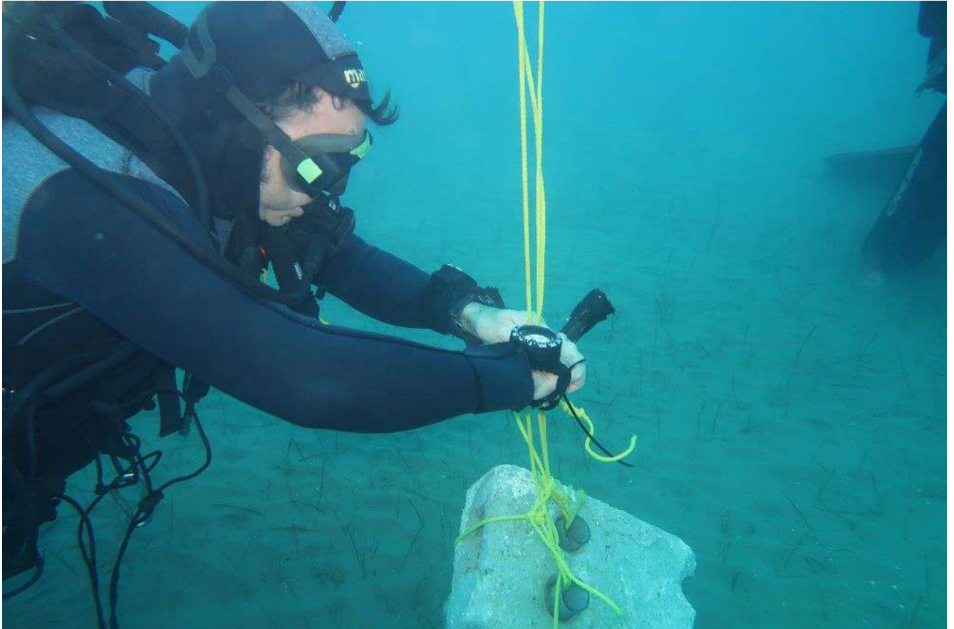
Fotografía 1: Instalación del sensor HOBO unido a un sistema de lastre
