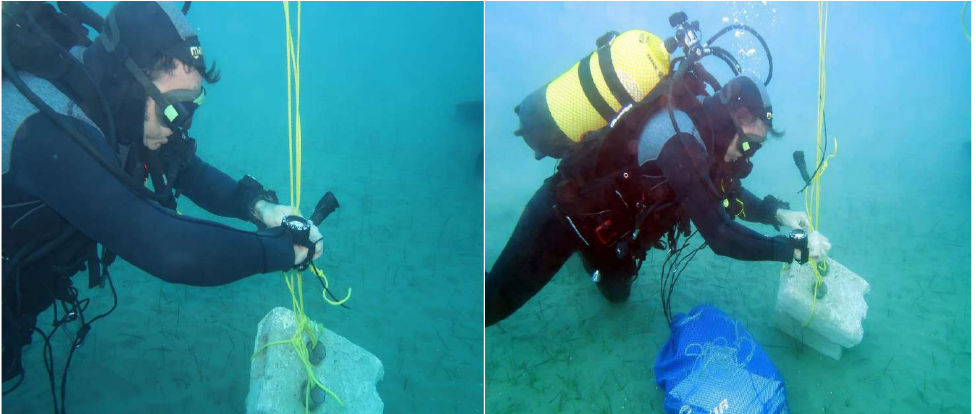
Fotografía 1: Instalación sensor HOBO, sobre un fondo de pradera de Cymodocea nodosa
