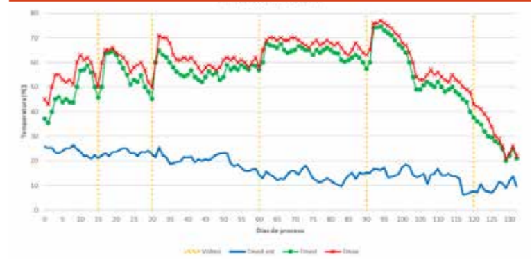
Figura 2. Perfil térmico de un lote de Agrocompostaje, con los volteos preestablecidos (0, 15, 30, 60 y 90 días). Nota: En el caso de la figura no se cumplió la condición de punto final de proceso a los 90 días por lo que se prolongó 30 días más realizando un nuevo volteo a los 120 días
