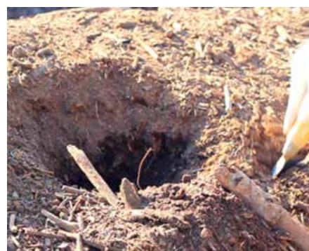
Realizar un agujero en la pila de compost para coger muestra de la zona central (despreciar capa superficial)
