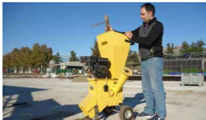
Biotritrador/desfibrador de martillos bajo rendimiento de alimentación manual
