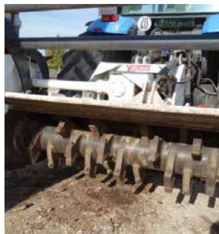
Muele leñas acoplado a toma de fuerza de tractor
