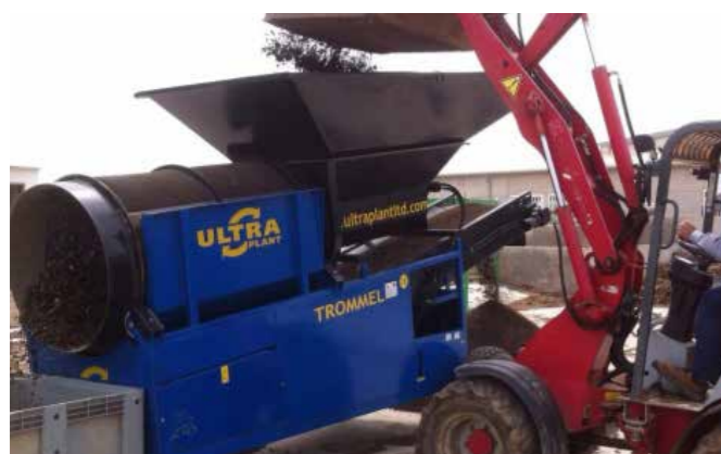
Cribado con equipamiento específico (tromel)
