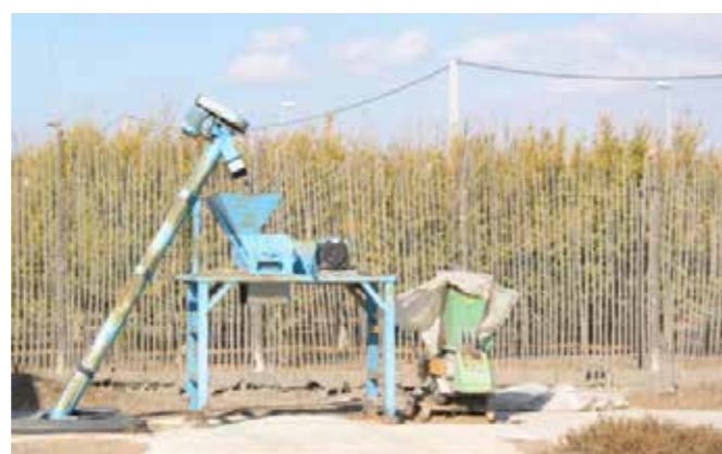
Molino con carga mediante sinfín
