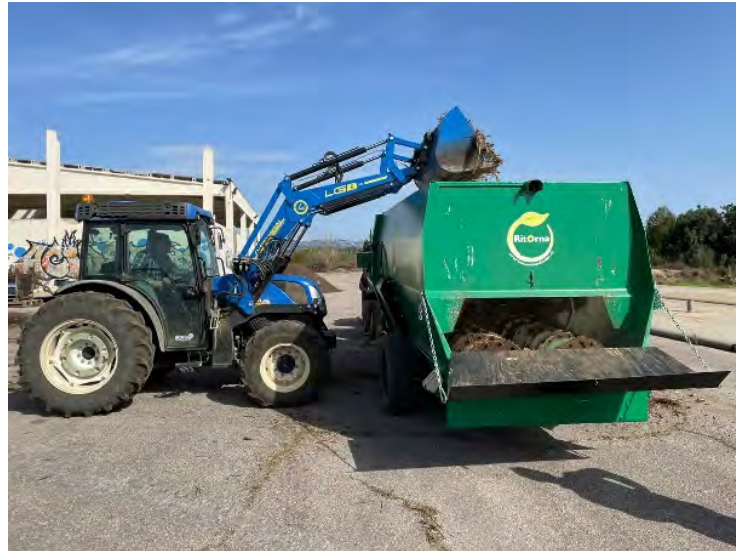
Imagen 5. Carga de la UNIFEED para el proceso de formación de las pilas
