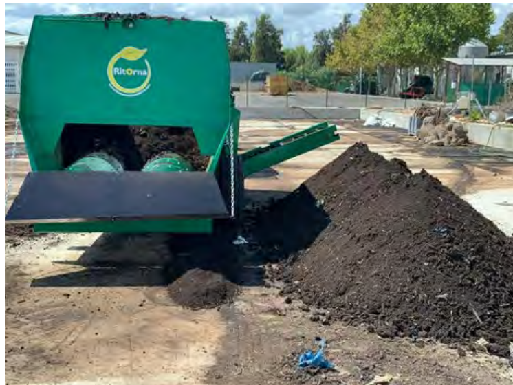
Imagen 6. Descarga de la maquinaria UNIFEED para el proceso de formación de las pilas
