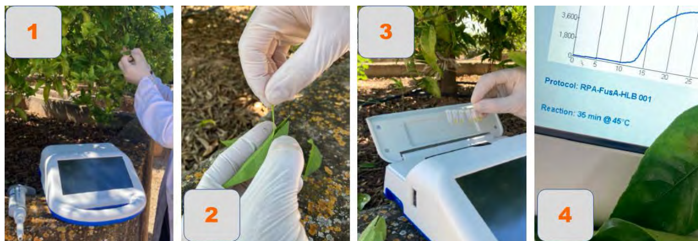
Figura 2. Exemple d'ús en camp del prototip de kit de detecció dels bacteris associats a l'HLB.
