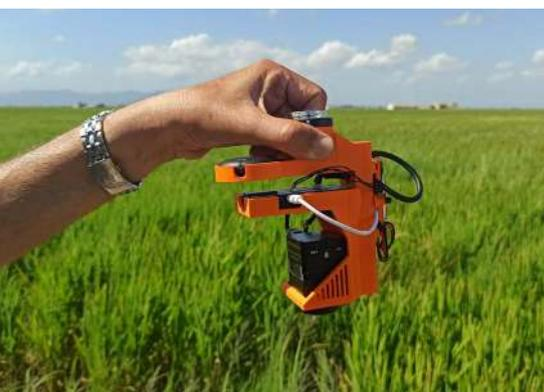
Para el estudio de la piricularia, se utiliza esta cámara térmica desarrollada para ser utilizada a bordo de un dron (foto: A. M. C.).
