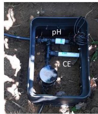
Respecto del análisis de agua, se instaló un sistema de monitorización en continuo de la calidad del agua de riego que permitió hacer un seguimiento exhaustivo de las características del agua utilizada.
