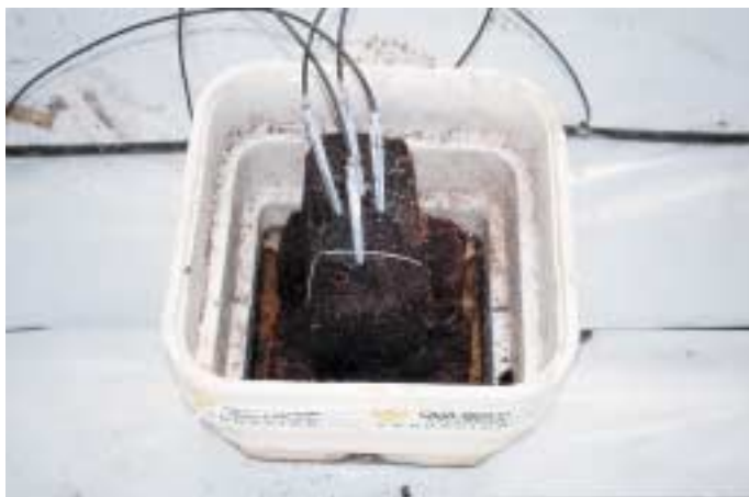
12. Hidratación de ladrillos comprimidos de fibra de coco.
