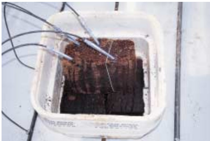
27. Proceso de hidratación de la fibra de coco y disposición del ladrillo, para evitar en el hinchado la rotura del contenedor
