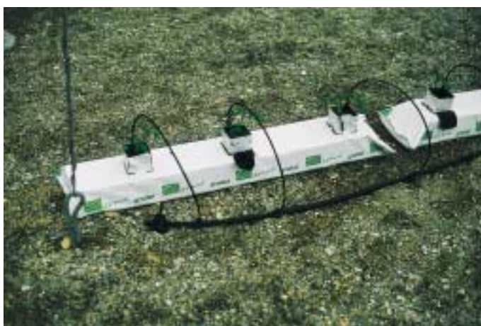
24. Elemento típico formado por: gotero, microtubo y piqueta.
