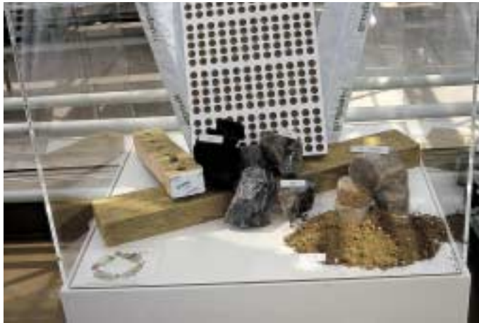
3. Distintas presentaciones de lana de roca: tabla, bloque, dado, materia prima para su fabricación y ladrillo procedente de su reciclado.
