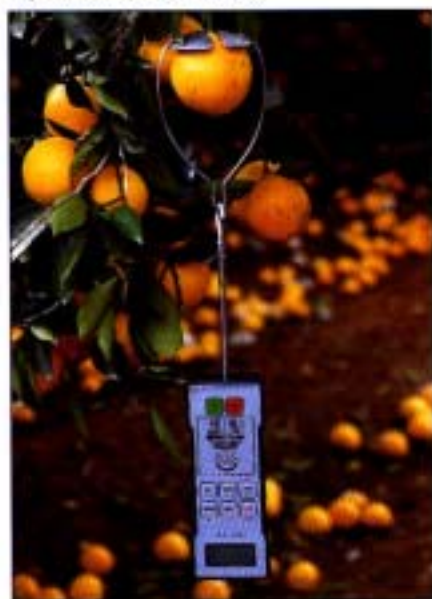
FOTOS 4 y 5. Dinamómetro adaptado para medir la fuerza de sujeción del fruto al pedúnculo en los cítricos.
