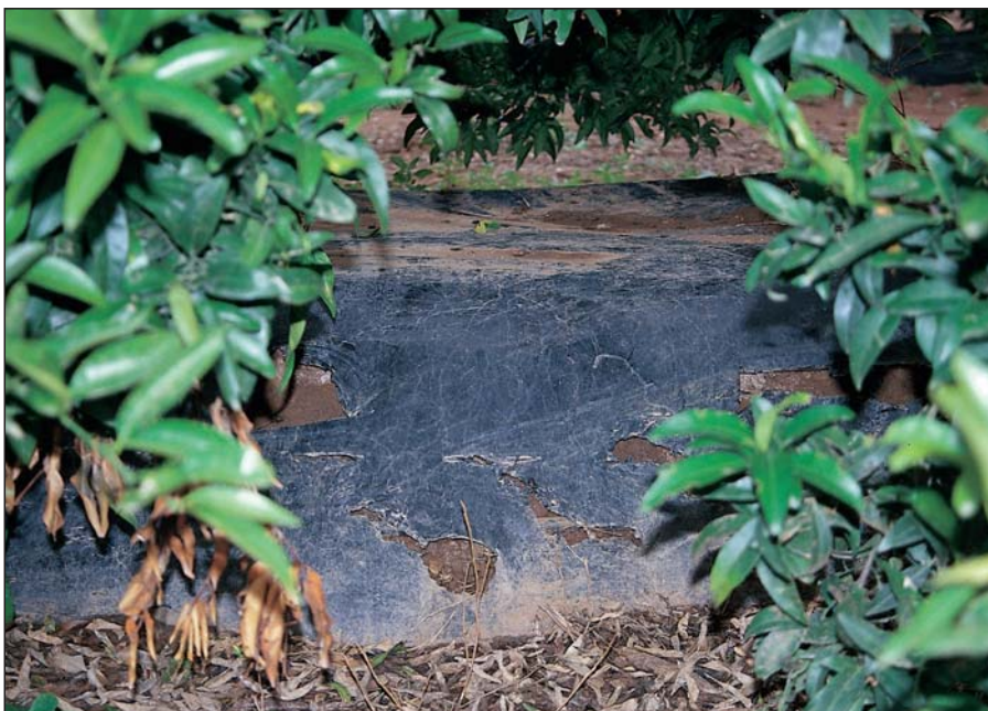
Foto 4. Estado del plástico a los 8 años de la colocación.
