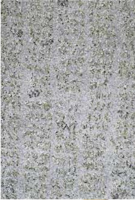
Foto 16. La lectura de membranas puede realizarse a simple vista o con ayuda de una lupa sencilla o binocular x5 ó x10 aumentos. En la foto x5 aumentos, se aprecian los positivos (secciones teñidas de color violeta-púrpura).
