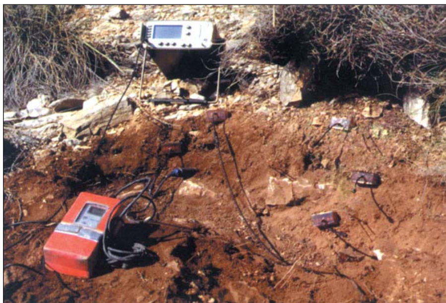
Foto 3. Medidas de la humedad del suelo en campo. Sensores y equipos TDR.
