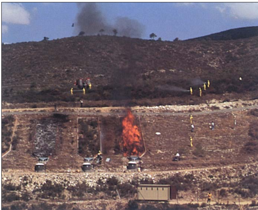
Foto 4. Fuegos experimentales para la determinación de los efectos de la intensidad del fuego en el suelo, la erosión y la vegetación.
