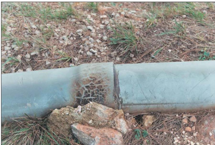
**Foto 3.** Unión por encolado en PVC. Instalación indebida en superficie y calentamiento indeseable de la unión en la instalación. ¿Duración posible? Escasa.
