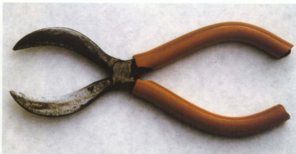
FOTOG. 3.-Tijeras diseñadas para realizar el rayado cuyos resultados se presentan en este trabajo.
