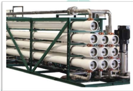
Una unidad típica de OI o NF (imagen de www.wateronline.com ).
