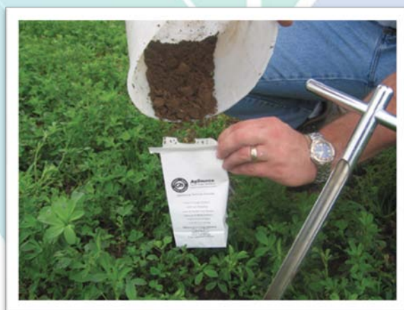
Figura 1 Toma de una muestra de suelo con una barrena ( http://cri.crinet.com/news2536/PlanNowForSpringSoilSampling )
