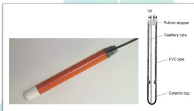
Figura 2 Muestreador de succión de solución de suelo
