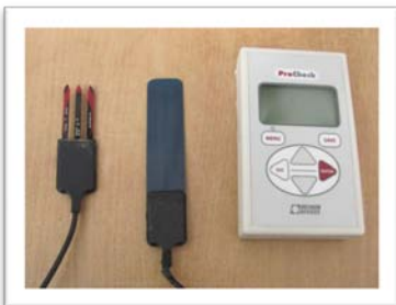
Diferents tipus de sensors d'humitat.
