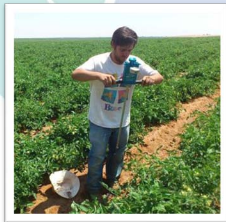
Mesurament del potencial hídric amb càmera de pressió en un cultiu de tomaca.
