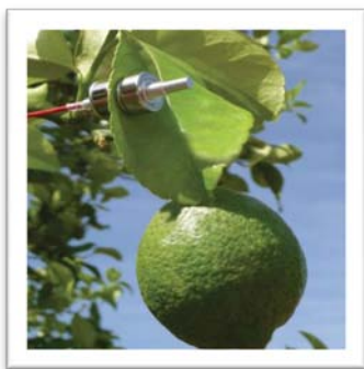
El sensor de turgència mesura en temps real els canvis en la pressió de turgència de la fulla.
