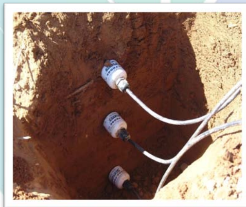
Sensor WET usat per a prendre mesures en llana de roca i sòl a l'aire lliure ( https://www.delta-t.co.uk ).
