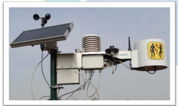
Estación meteorológica automática.
