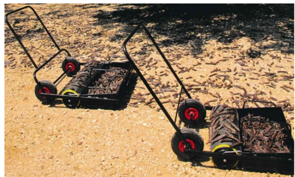
Figura 6. Màquina amb corró de pues per la recollida de les garrofes (AGROLIVE).
