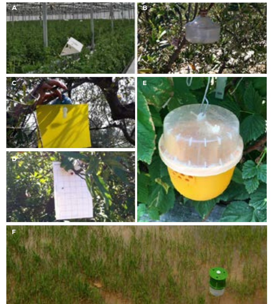
Figura 1. Dispositius per al seguiment de poblacions A. Tuta absoluta B y C. Bactrocera oleae (femelles i mascles) D. Aonidiella aurantii E. Chilo suppressalis F. Drosophila suzukii
