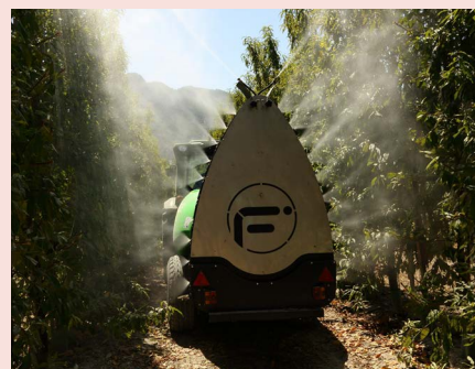
Tres versions de l'atomitzador intel·ligent H3O, cadascuna d'elles adaptada a les particulars condicions de diferents cultius especials.
