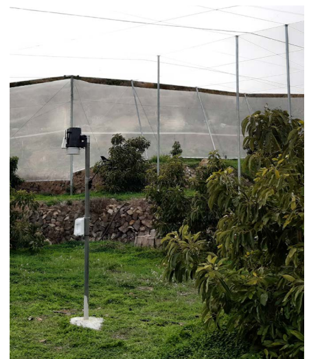
Estació agrometeorològica sota malla d'ombra.
