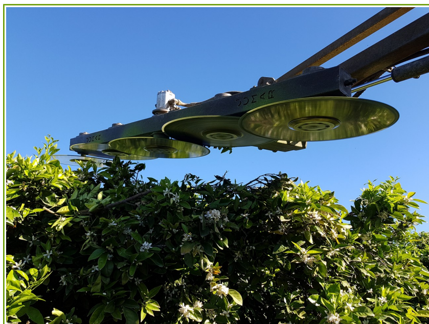
Árboles rebajados con máquina de discos. Navelina. Poble Llarga. (Arriba). Detalle de los discos. (abajo). Fuente: Sección de Estudios Agrarios. D.T. Valencia.
