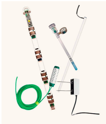
Imatge 3. Bateria de tensiòmetres per a control del reg en pimentó (Pilar de la Horadada).
