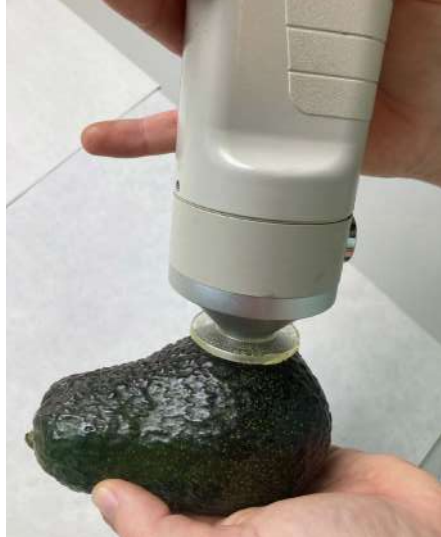
Medición del color externo, interno y firmeza de frutos de aguacate Lamb Hass (foto A. S.).
