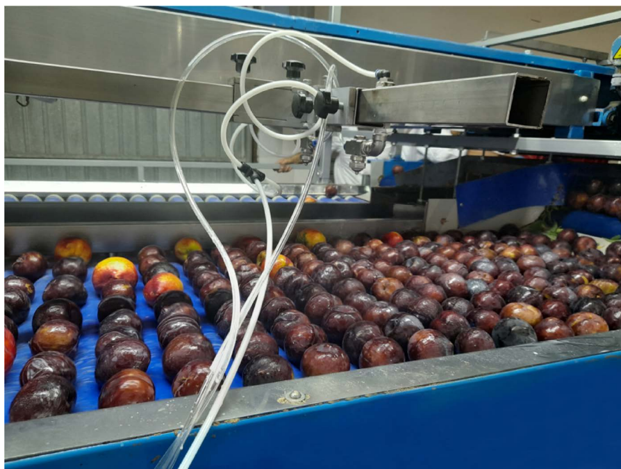
Aplicación de recubrimientos comestibles antifúngicos en líneas de confección de fruta en centrales empacadoras.
