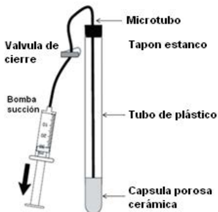
FIGURA 1 ESQUEMA Y FOTOGRAFÍA DE LISÍMETRO PARA LA EXTRACCIÓN DE LA SOLUCIÓN DEL SUELO.
