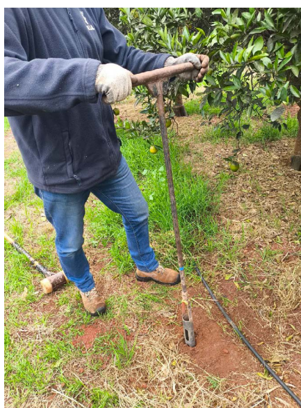
Barrenando el suelo para hacer el agujero donde insertar el lisímetro.
